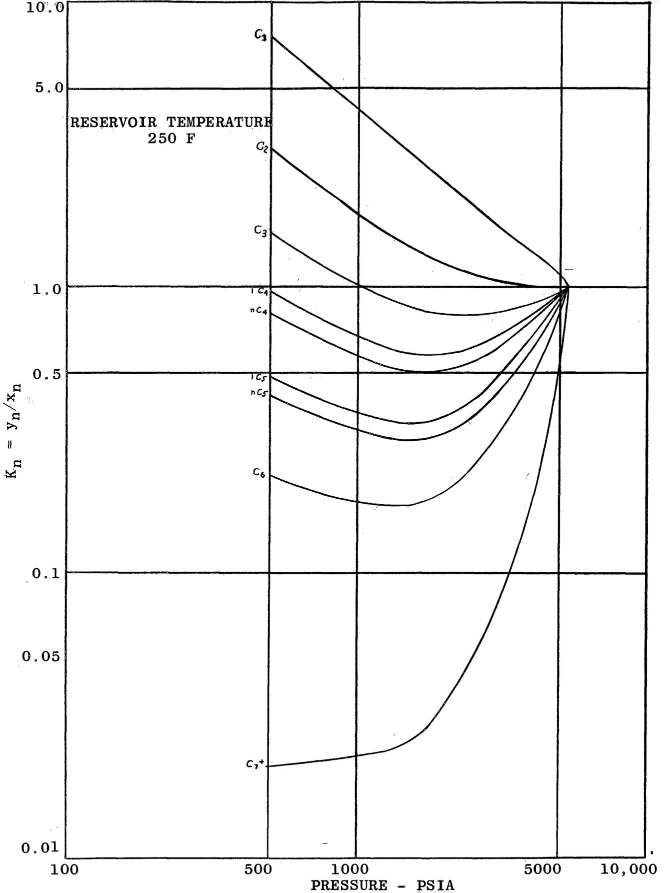
FIGURE 4 - EQUILIBRIUM-VAPORIZATION RATIO CHART, FLUID B
