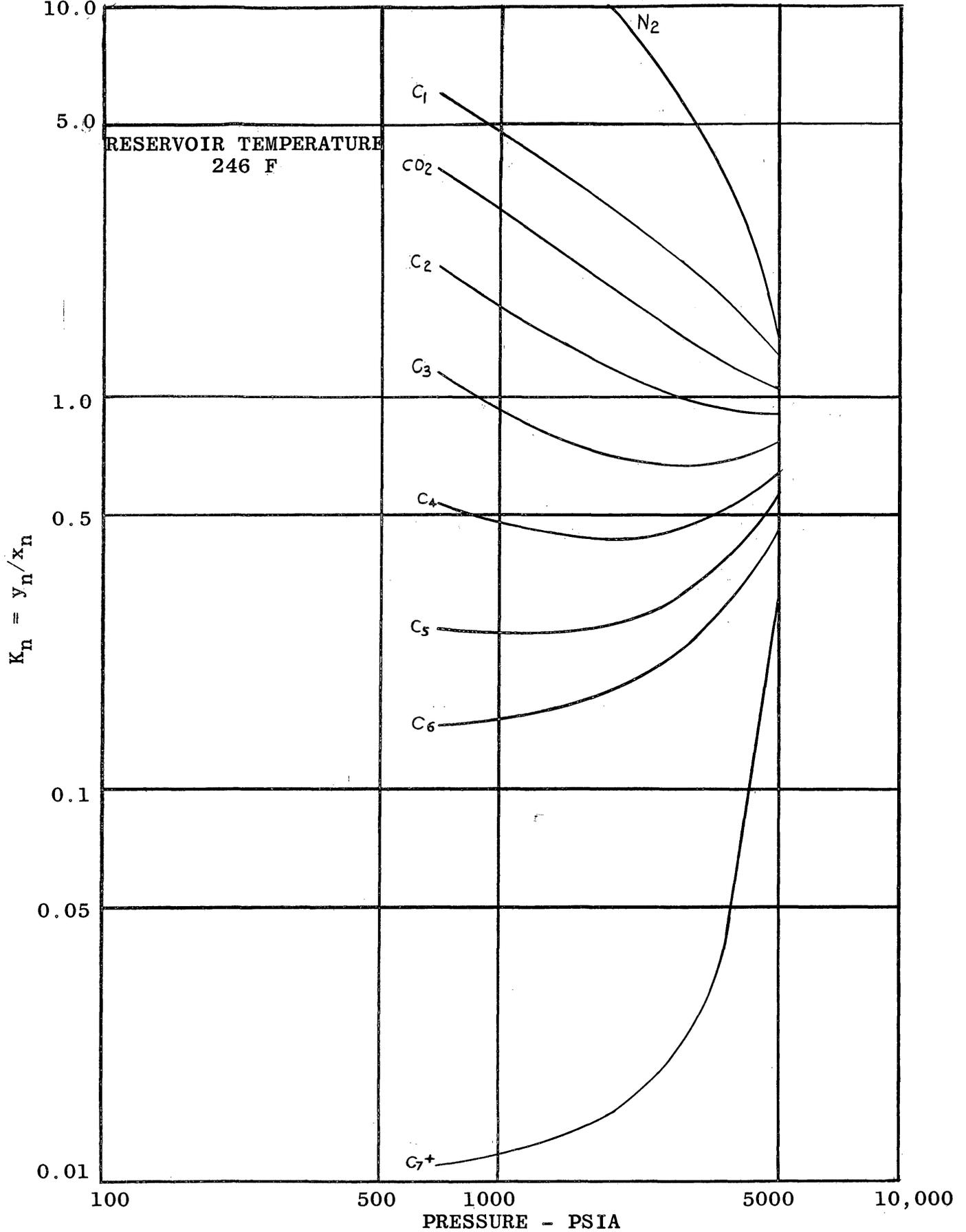
FIGURE 2 - EQUILIBRIUM-VAPORIZATION RATIO CHART, FLUID A
