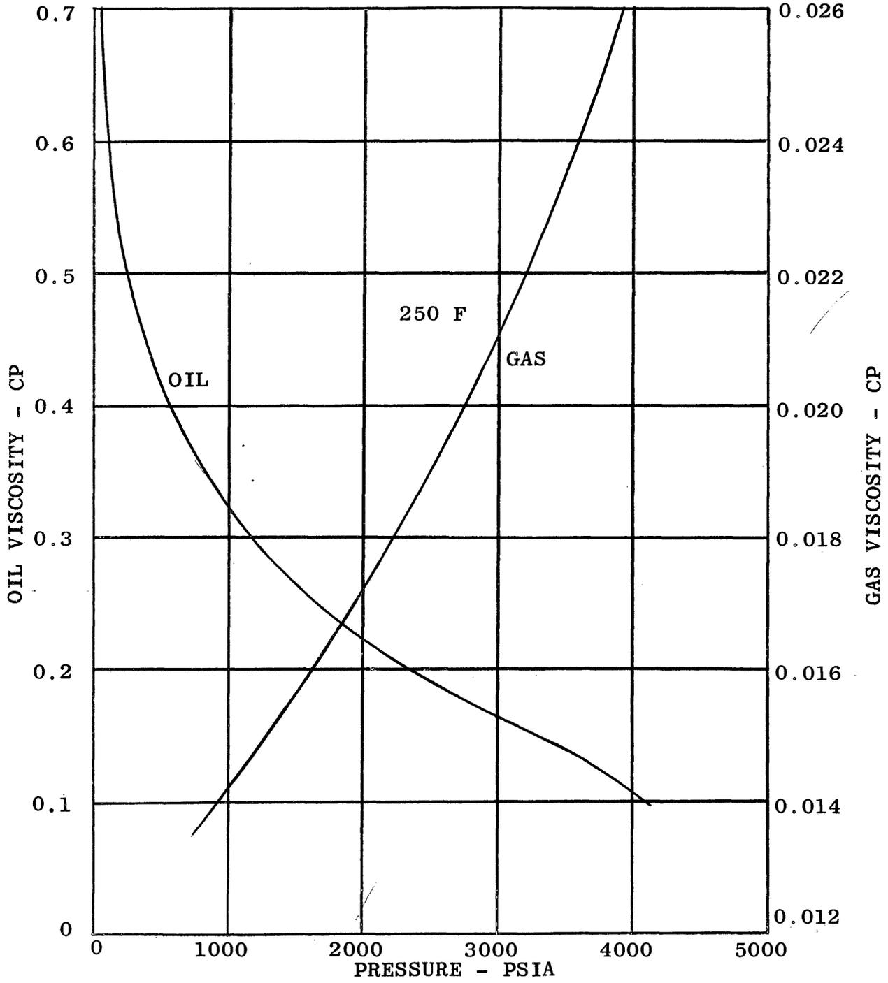
FIGURE 5 - GAS-OIL VISCOSITY DATA, FLUID B
