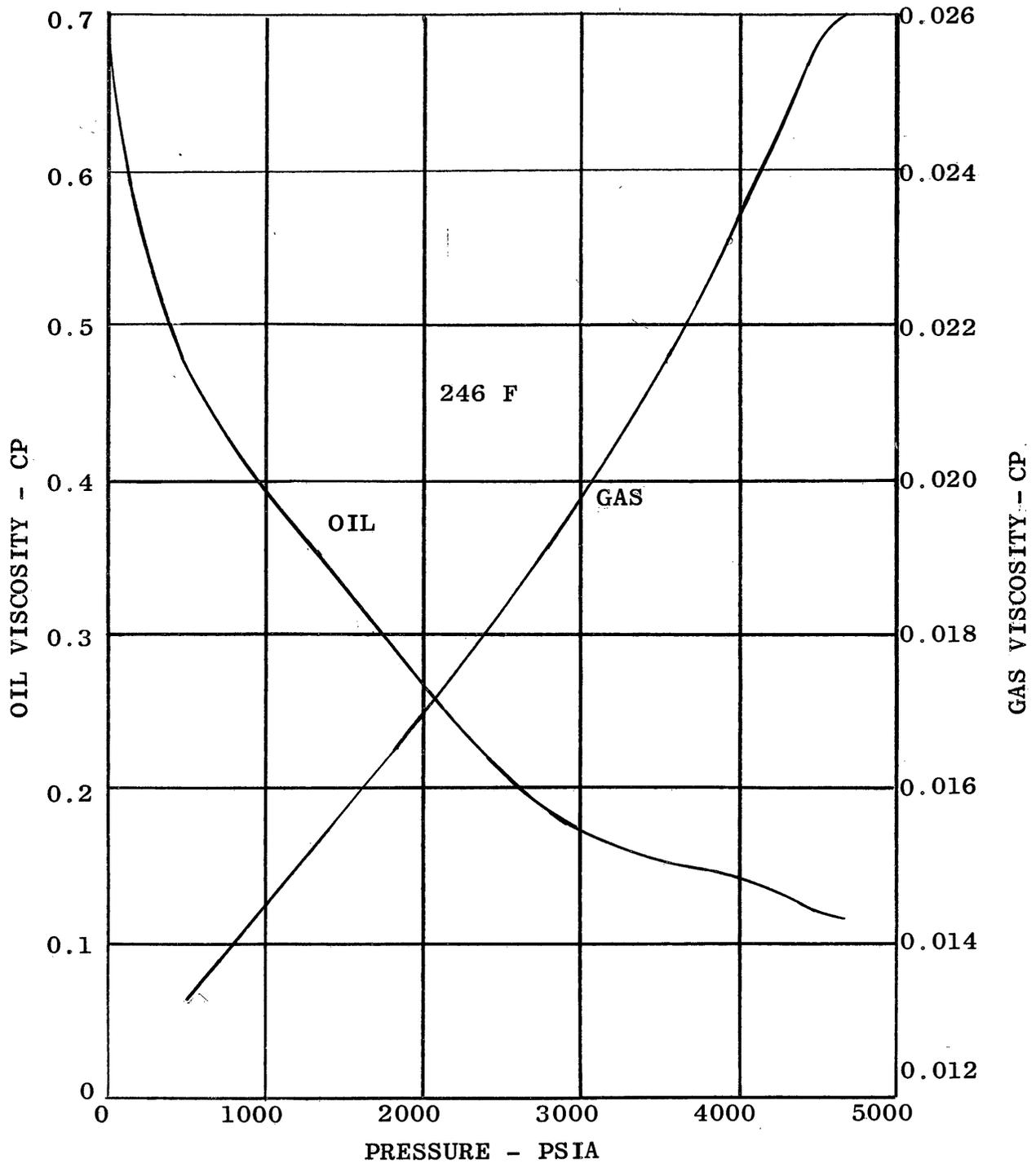
FIGURE 3 - GAS-OIL VISCOSITY DATA, FLUID A
